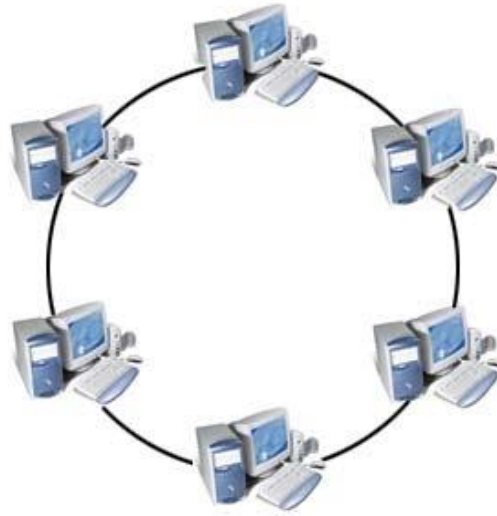
ภาพที่ 2.13 แสดงของโครงสร้างแบบแหวน (Ring network)
